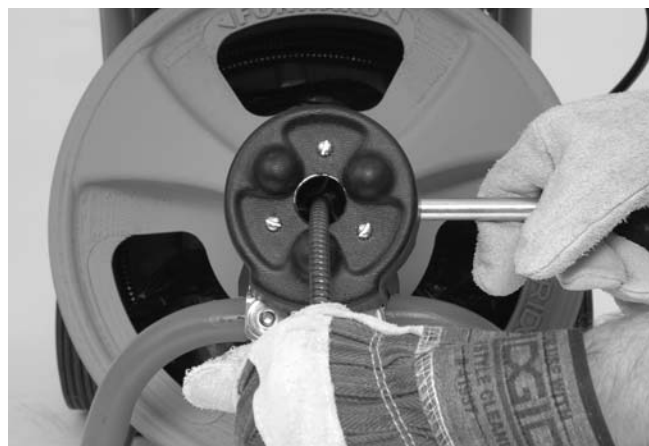
Figure 14 – Système d'avancement automatique en position « récupération »
