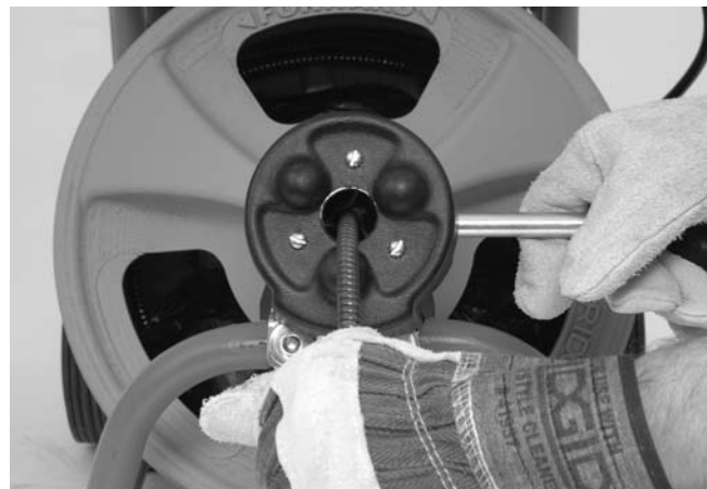
Figura 14 – AUTOFEED en posición para retraer el cable
