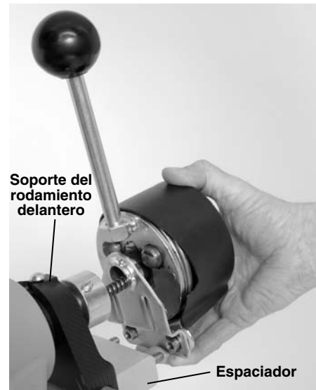
Figura 4 – Montaje del AUTOFEED a la armazón
