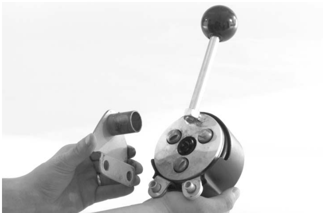
Figure 3 – Installation du support de montage sur l'AUTOFEED
