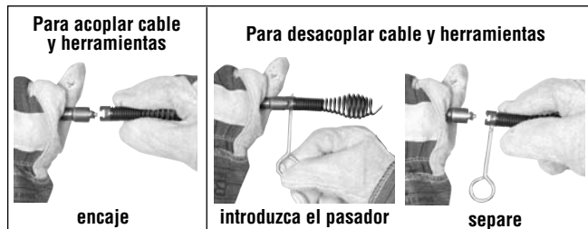
Figura 11 – Acoplamiento y desacoplamiento de herramientas en la punta del cable
