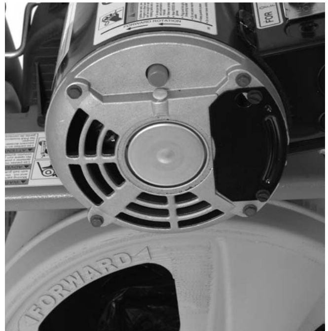
Figure 8 – Flèches de sens de rotation du tambour
