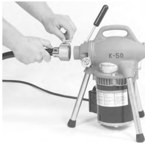
Figura 2 – Acoplamiento de la manguera guía trasera
