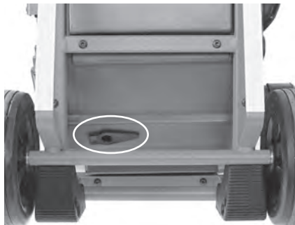
Figura 11 - Tapón de drenaje
