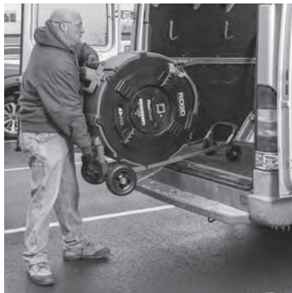
Figura 14 - Colocación de la máquina en el camión
